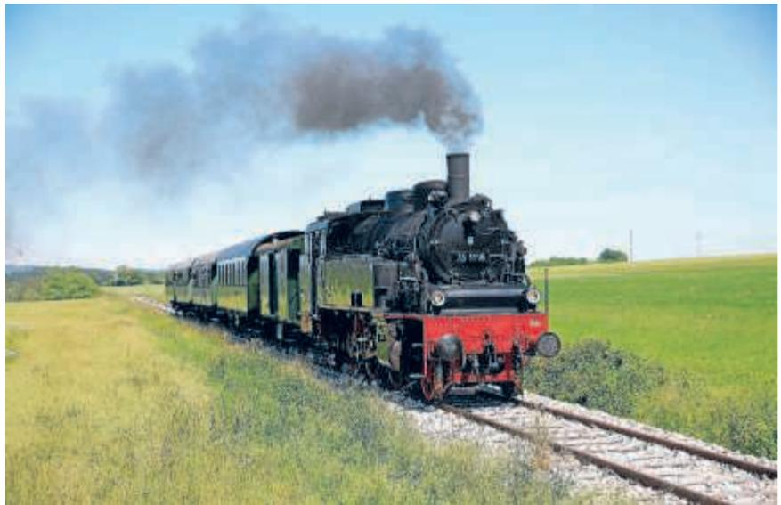
76 Tonnen schwer, 790 PS stark, 90 Stundenkilometer schnell und fast 13 Meter lang, das sind die technischen Daten der Dampflok, die am 26. Juli 2020 auf der Krebsbachtalbahn verkehren wird.
