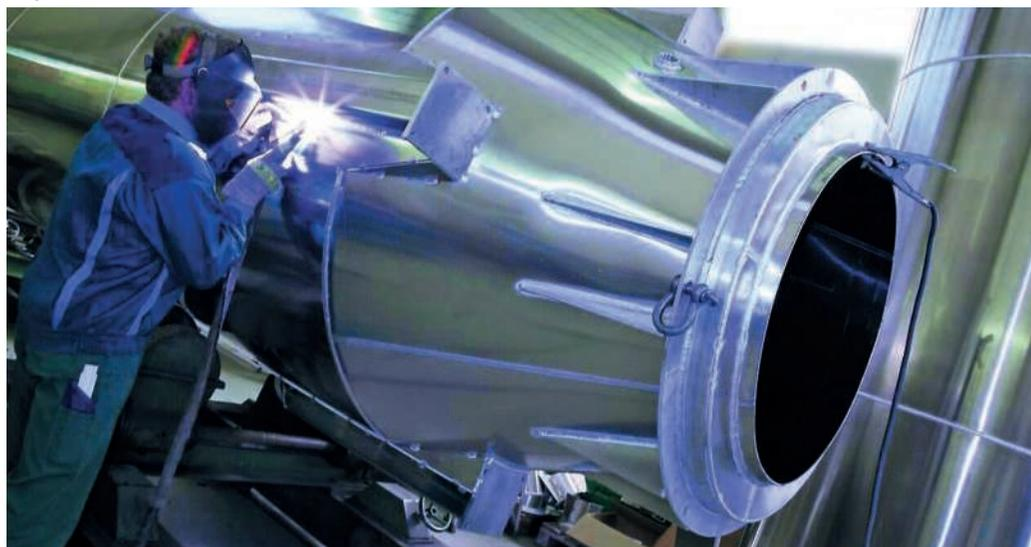
Aus dem Neckar-Odenwald-Kreis in die ganze Welt: Ein Teil einer automatischer Zuführungsanlage entsteht bei der AZO GmbH + Co. KG in Osterburken. Foto: Firmenfoto
